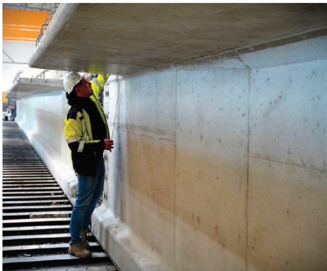
Belki MG-T 40 o wysokości 1,9 m na torze produkcyjnym po sprzężeniu
