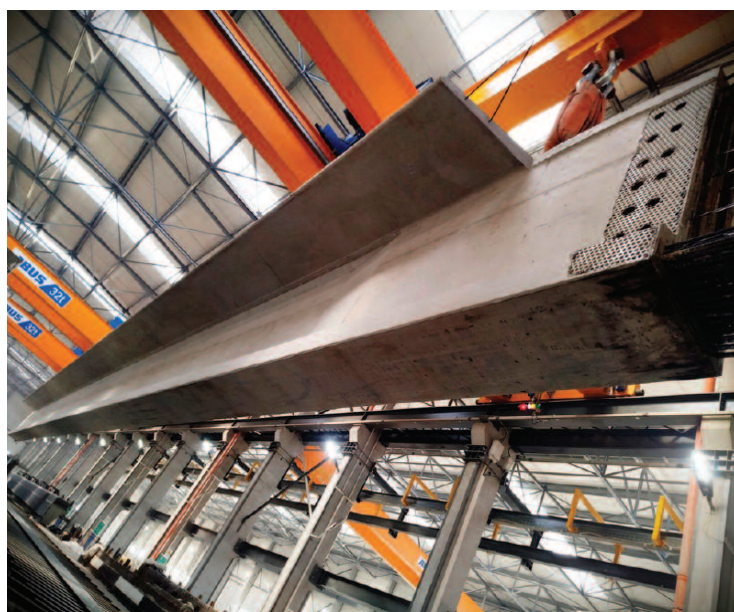
Transport belki MG-T 40 do magazynu sunicami, o łącznym udźwigu 128 ton
