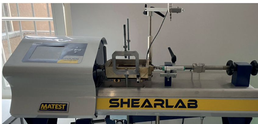
Laboratory setup used in experiments to calibrate numerical models Photo: author Stanowisko laboratoryjne użyte w badaniach służących do kalibracji modelu numerycznego Fot. autor
