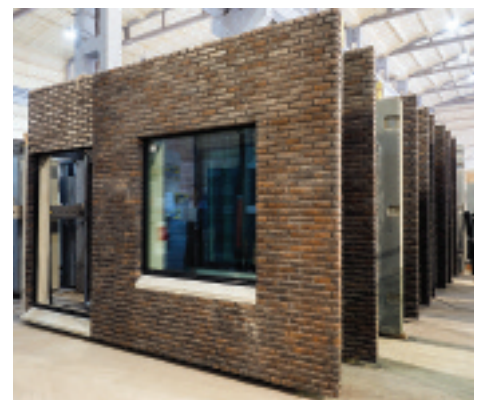
Fot. 1. Prefabrykowane ściany trójwarstwowe wyprodukowane przez Pekabex na potrzeby projektu Solna United w Sztokholmie
