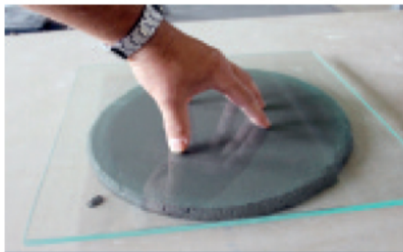
Fot. 1. Klej rozpływny wypełnia całą przestrzeń między płytką a podłożem
