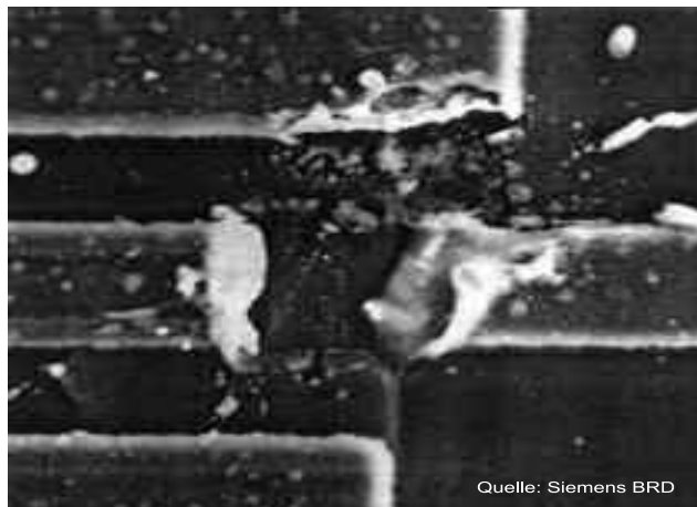
Typowe uszkodzenie typu ES
